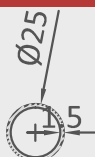
INOX ΣΩΛΗΝΑΣ SATINE \Phi 25 \times 1,5\text{mm} INOX SATINE PIPE \Phi 25 \times 1,5\text{mm} L=2.000mm or 4.000mm
